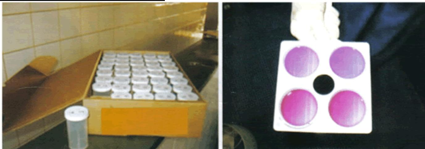
Frascos para coleta de amostra de leite para contagem eletrônica de células somáticas e teste de CMT
