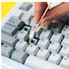
**Remova o revestimento das teclas** – Com uma pequena chave de fenda, retire cada tecla cuidadosamente. Elas devem se soltar com facilidade. Não remova a barra de espaço nem teclas grandes, como Shift, Enter e Tab. Pode ser difícil recolocá-las.
