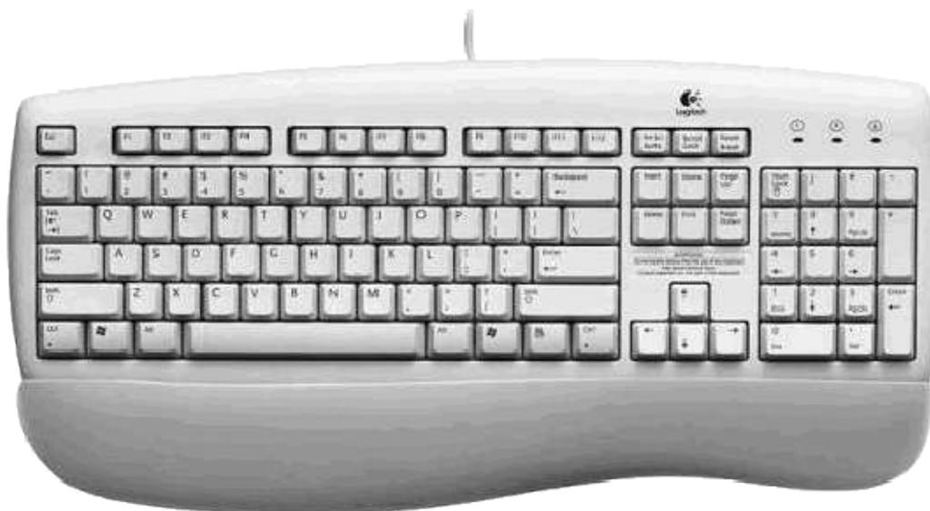
Manter o teclado limpo é fácil e a rotina de asseio deve ser adotada regularmente. Antes de começar o trabalho, verifique se seu teclado é mecânico ou com membrana. Alguns teclados ainda usam aparato mecânico sob as teclas, o que gera um clique diferente quando são pressionadas. A maioria dos teclado atuais, no entanto, utiliza teclas que se conectam a uma membrana plástica.
